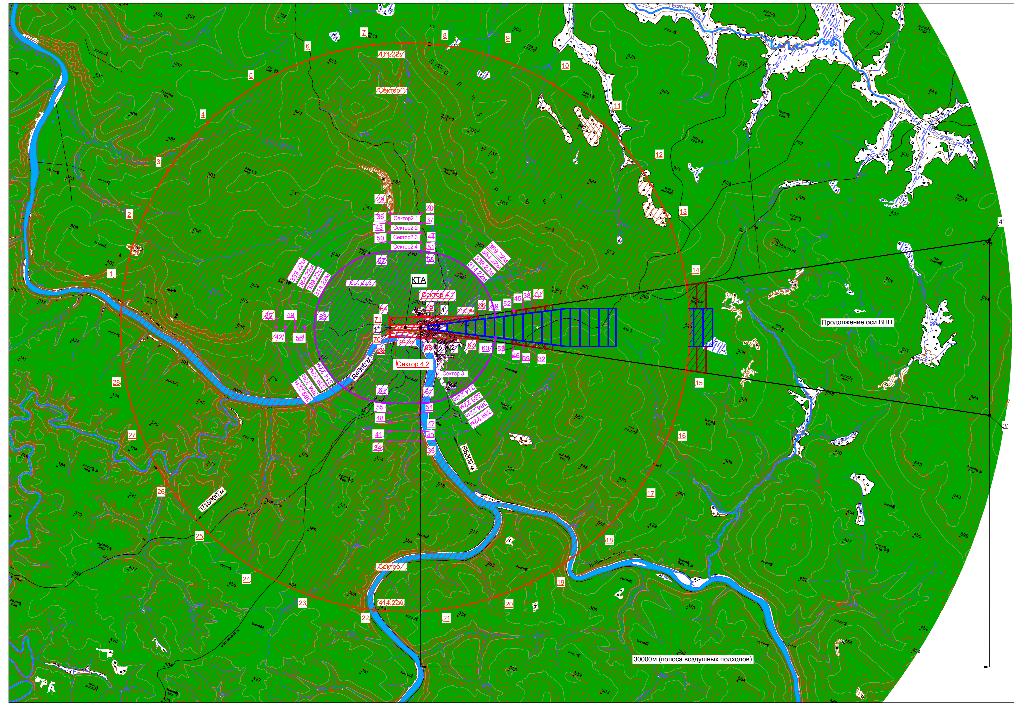
Третья подзона приаэродромной территории аэродрома Байкит с указанием ограничения по высоте строительства объектов в пределах границ полос воздушных подходов М 1:100 000
